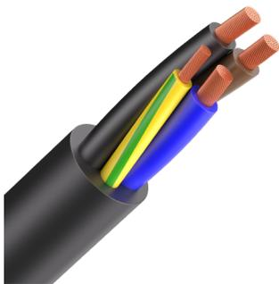
Кабель силовой гибкий, не распространяющий горение при групповой прокладке, с медными жилами, с изоляцией и наружной оболочкой из термопластичных эластомеров (термоэластопластов)
