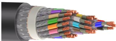
Кабель судовой огнестойкий, с изоляцией из сшитого полиэтилена, с индивидуальным экраном по жиле (паре, тройке, четверке), в оболочке из полимерной композиции, не содержащей галогенов, не распространяющий горения при групповой прокладке и не выделяющий коррозионно-активных газообразных продуктов при горении и тлении, в общем экране и защитной наружной оболочке
