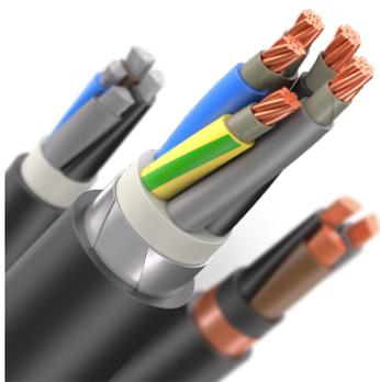
Кабели силовые с алюминиевыми жилами, с изоляцией из сшитого полиэтилена, с броней в виде обмотки из двух стальных оцинкованных лент и защитным шлангом из полиэтилена
