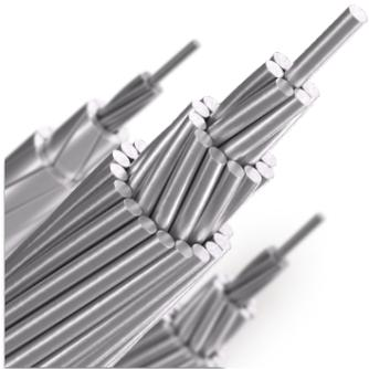
Провод, состоящий из стального сердечника, выполненного из стальных оцинкованных проволок нормальной прочности, и ТПЧ из проволок термообработанного алюминиевого сплава системы алюминий - кремний - магний марки АВЕ
