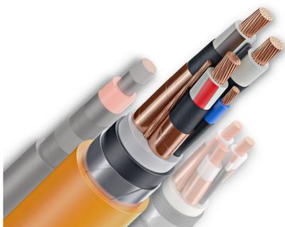
Изоляция из этиленпропиленовой резины, с медным экраном, броня из проволок алюминиевого сплава, наружная оболочка из полимерной композиции, не содержащей галогенов.
